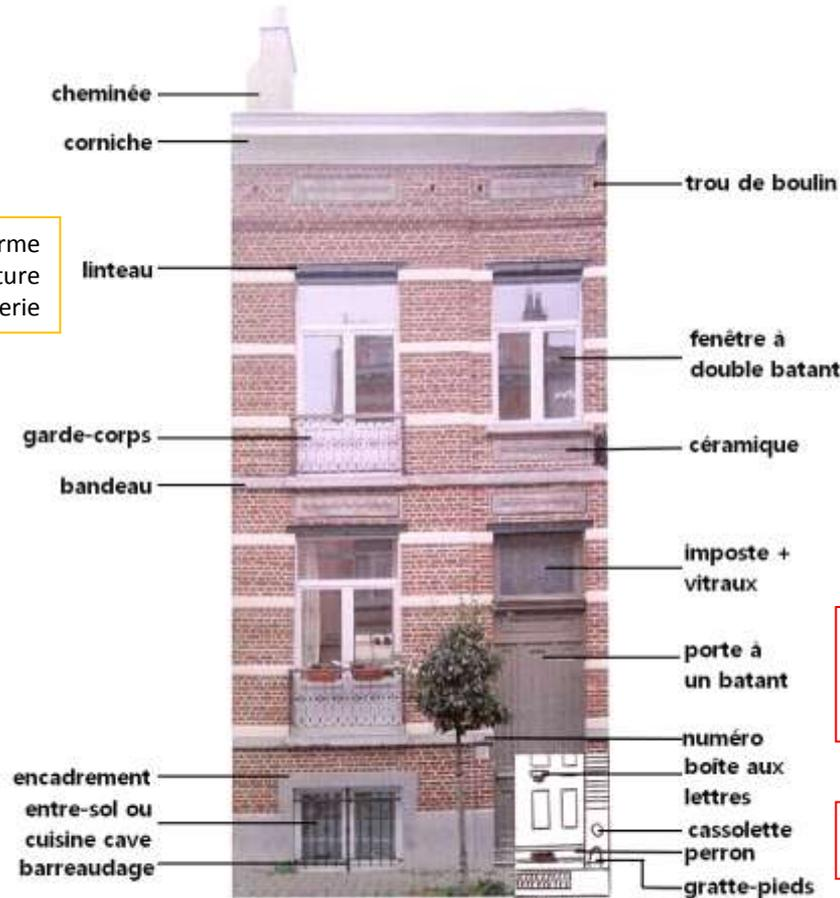
Pièce horizontale en métal qui forme la partie supérieure d'une ouverture et soutien la maçonnerie
